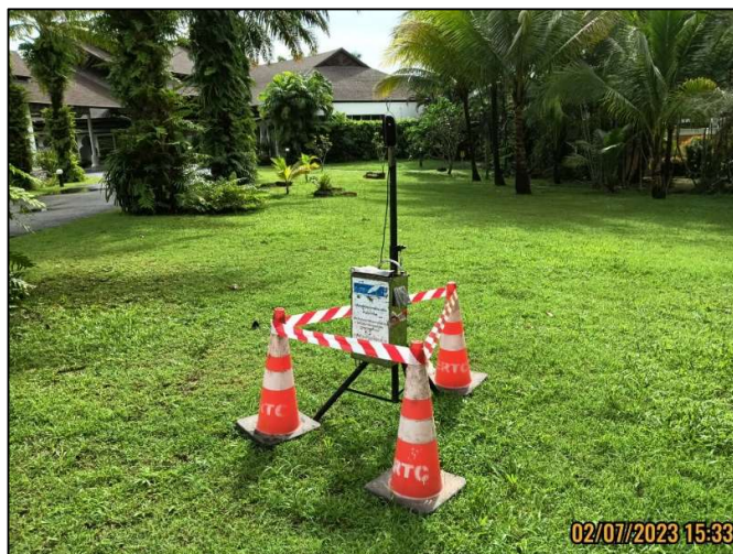
รูปที่ 3-15 การตรวจวัดเสียงบริเวณพื้นที่โครงการ
